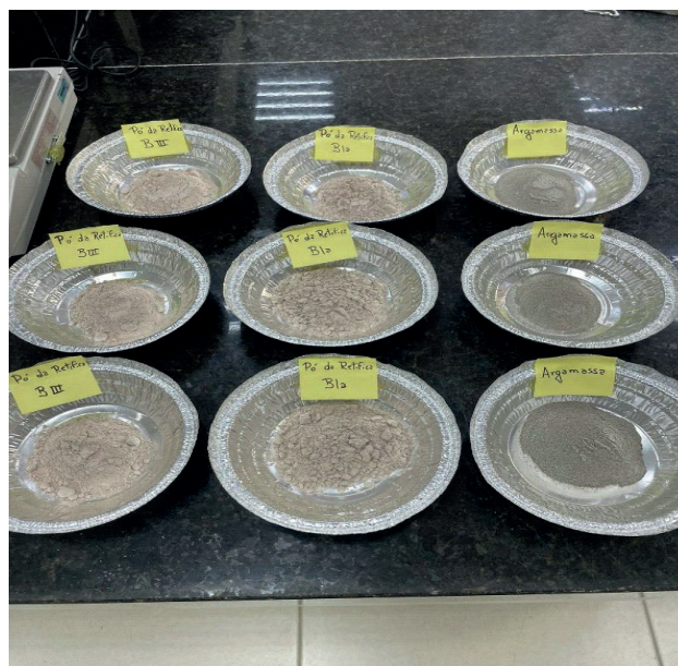
Figura 3. Amostras para ensaio de determinação de umidade Fonte: Autor (2021)
