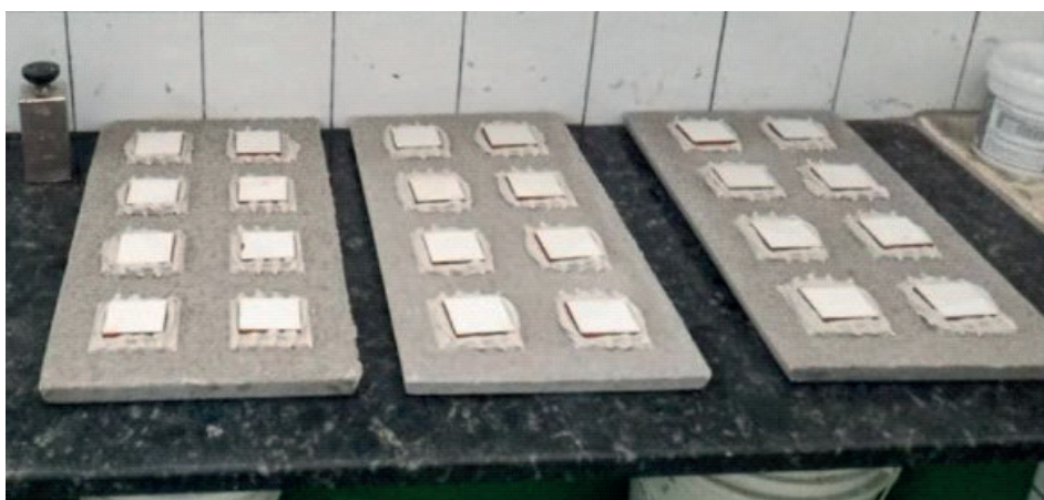
Figura 6. Placa de concreto com os corpos de prova.
