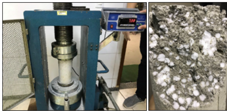
Figura 9. Ruptura de corpo de prova
