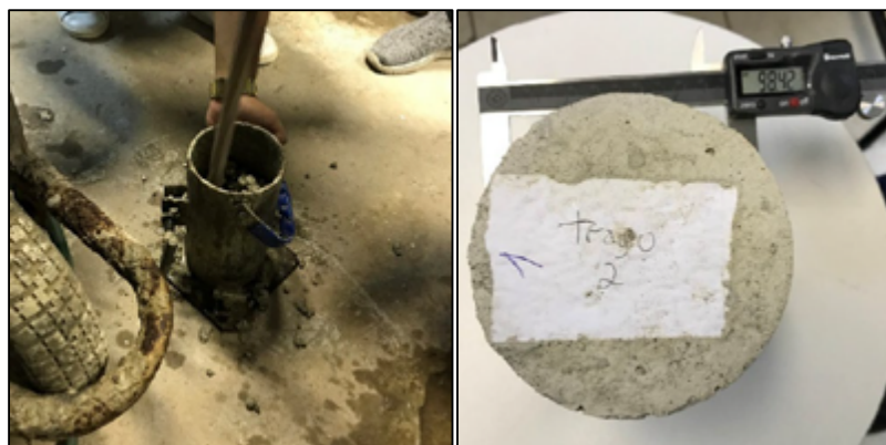
Figura 7. Preenchimento do molde com concreto
