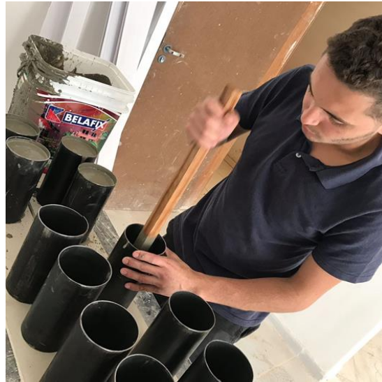
Figura 5. Preenchimento do perfil tubular circular.
