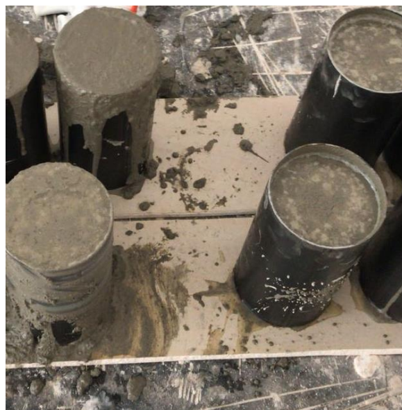
Figura 6. Preenchimento do perfil tubular circular.
