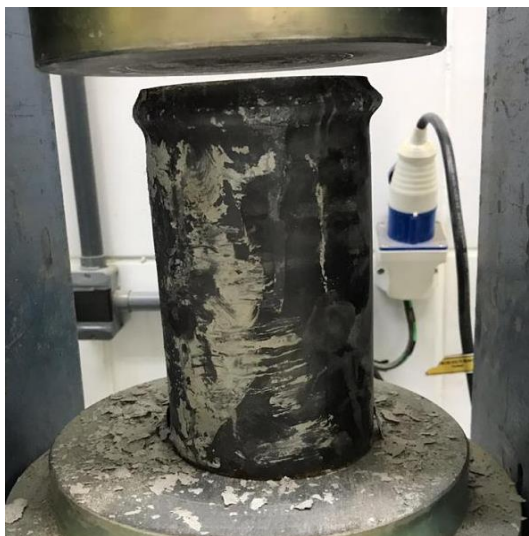
Figura 10. Final do rompimento perfil tubular circular.
