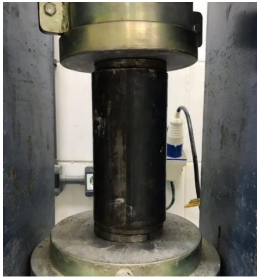
Figura 8. Rompimento perfil tubular circular – chapas metálicas.
