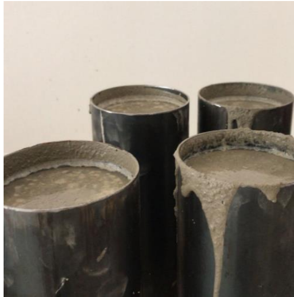
Figura 7. Preenchimento do perfil tubular circular.
