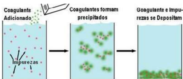
Figura 11. Floculação e decantação. Fonte: Naturaltec (2005).
