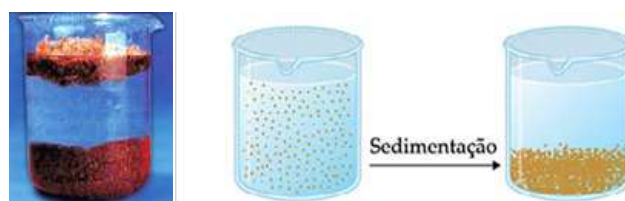
Figura 9. Processo de flotação e de sedimentação, respectivamente. Fonte: A graça da química (2015) e Coceeducação.com.br (2015).
