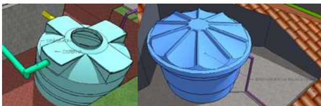
Figura 18. Reservatórios inferior e superior, respectivamente. Fonte: Elaborado pelos autores.
