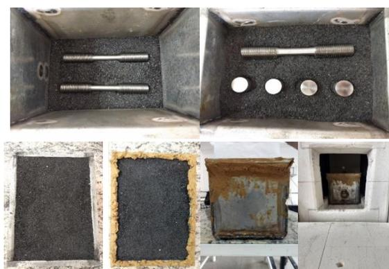
**Figura 3.** Etapas do processo de preparo dos testes de cementação
