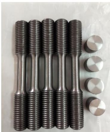
**Figura 2.** Amostras do aço SAE 4140 para tratamento de cementação em caixa
