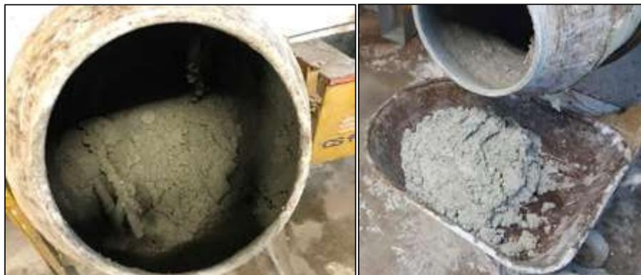
**Figura 5.** Concreto após o amassamento
