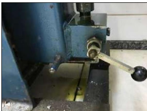
**Figura 8.** Vazamento de óleo hidráulico na prensa
