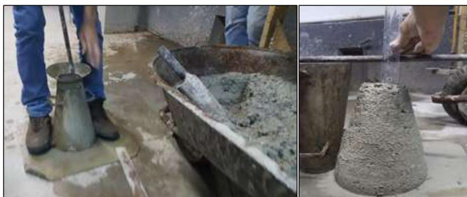
**Figura 6.** Enchimento de corpo de prova tronco-cônico
