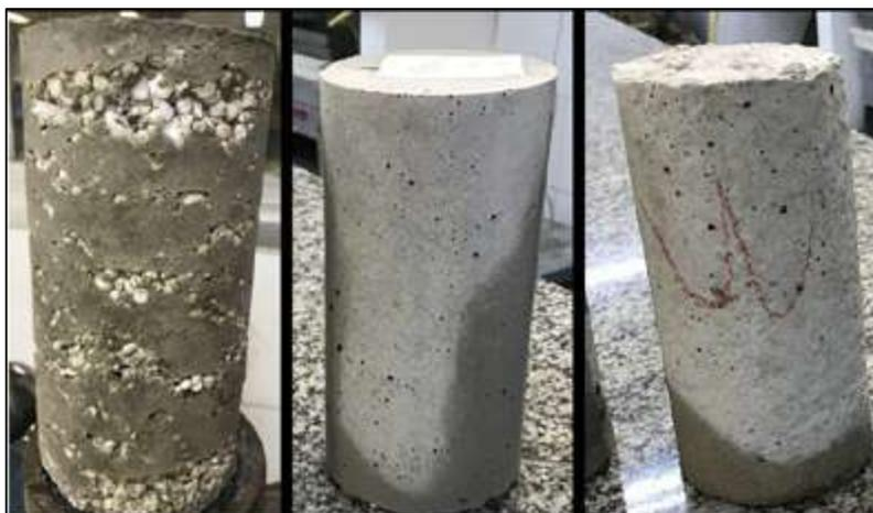
Figura 10. Corpos de prova dos traços 1, 2 e 3 com 21 dias.
