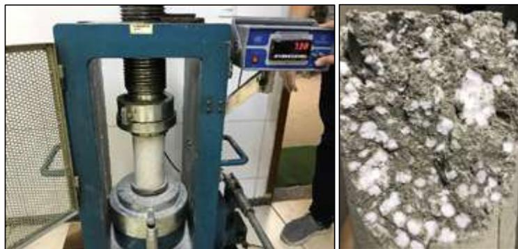
**Figura 9.** Ruptura de corpo de prova
