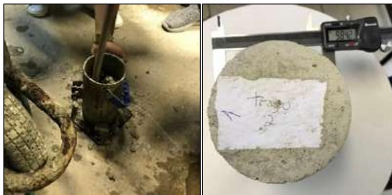
**Figura 7.** Preenchimento do molde com concreto
