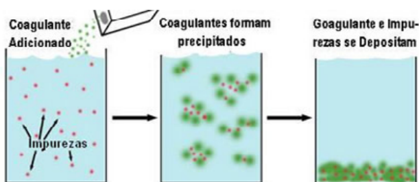
Figura 11. Floculação e decantação.
