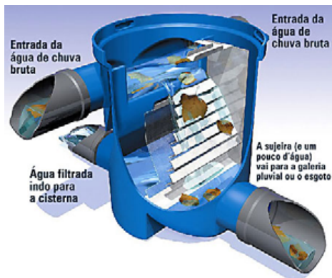
Figura 4. Filtro polietileno. Fonte: Creaconstruir.blogspot.com (2012).
